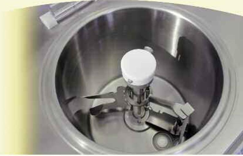
Los Mixcrema 30 y 55 de la línea Technogel son máquinas completamente automáticas para la producción de las cremas pasteleras, chocolates templados, bases de helados, mermeladas como también bases para turrones. Construidas totalmente en acero inoxidable, con todos sus componentes desmontables para una mejor limpieza, están compuestas de las siguientes partes:
